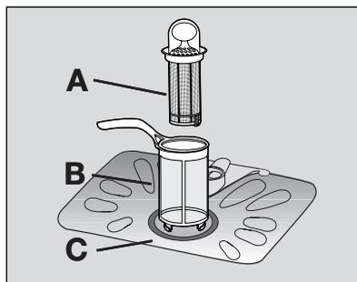
1. Drücken Sie zum Entriegeln der Filter (A) und (B) den Griff des Mikrofilters (B) etwa 1/4 Umdrehung nach links und entnehmen Sie diesen.
